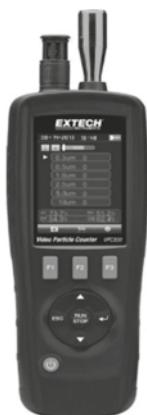
**Figura 4.** *Instrumento empleado para el monitoreo de material particulado*
